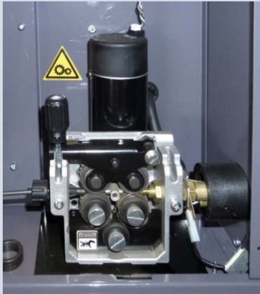
Drahtvorschubeinheit mit 4 Rollen 4-roller wire feeder
